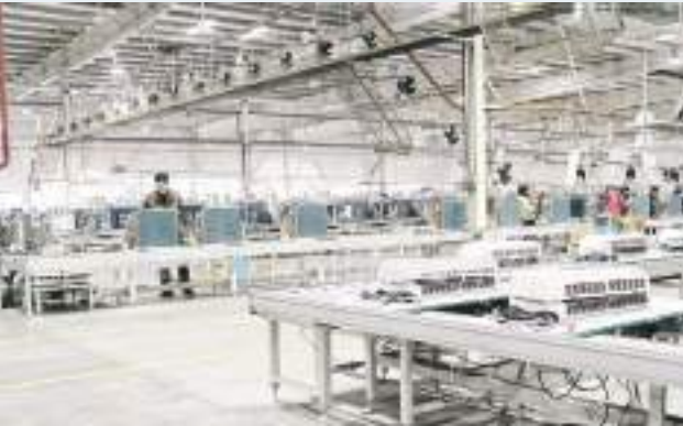
مصنع تغليب للمرحلة الثانية لعملية التصنيع يظهر الشكل الناقل العلوي لنقل المواد
